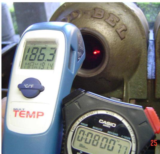
Figura 1 - Medição da temperatura dos grãos em movimento.
