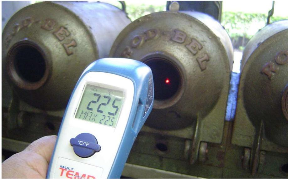
Figura 2 - Medição da temperatura da massa dos grãos de café.
