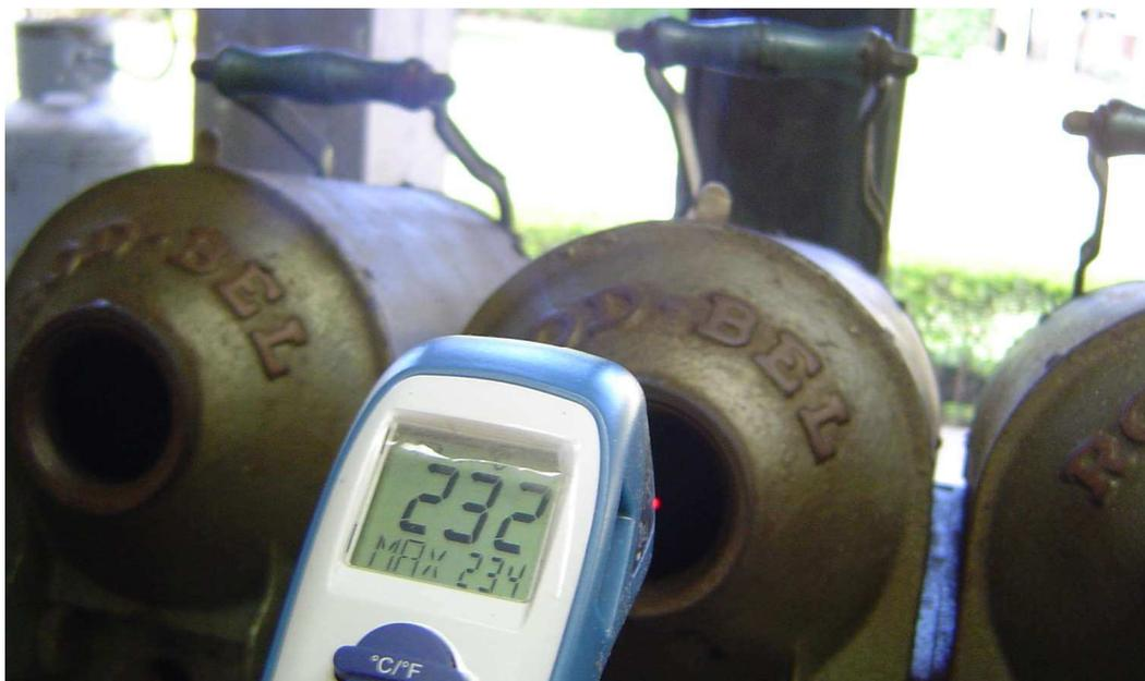
Figura 1 - Medição da temperatura dos grãos durante o processo de torrefação.
