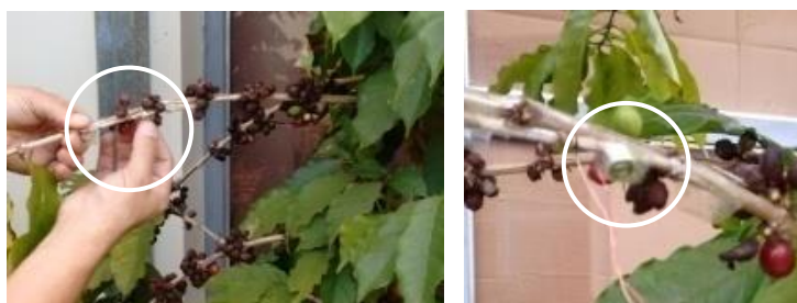
Figura 42 - Posicionamento do microfone de eletreto no ramo (c) e (d).
