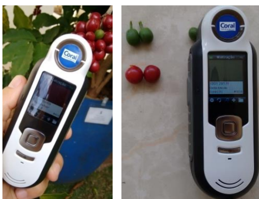
Figura 22 - Equipamento para verificação do padrão de cores CULUS Listed 9M30 Measurement Equipament5V @ 500mA x-rite Model RM200.
