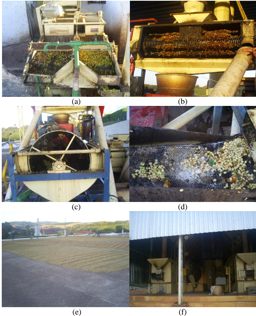
Figura 5. Etapas do processamento via semi-úmida: (a) Separação dos grãos cereja, verdes e bóias; (b) Despulpamento por prensagem; (c) Tambor de lavagem; (d) Grãos de café descascados; (e) Secagem em terreiro; (f) Secadores rotativos.
