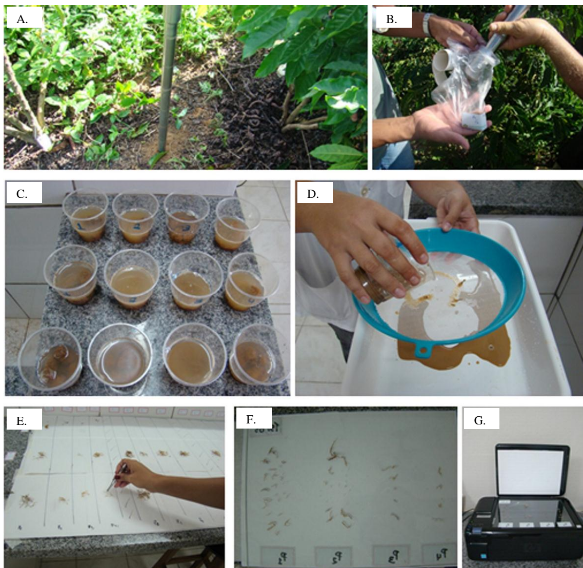
Figura 2. Coleta dos monólitos de solo com raízes (A.), acondicionamento das amostras em sacolas plásticas (B.), distribuição dos monólitos em copos transparentes (C.), separação das raízes em água corrente sob peneira (D.), secagem das raízes em papel absorvente (E.), arranjo das raízes lavadas entre placas de vidro (F.), digitalização das imagens de raízes de plantas do cafeeiro conilon irrigadas e de sequeiro, em quatro profundidades (G.)
