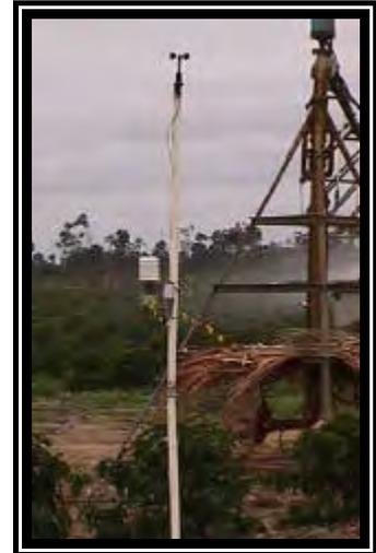
Figura 2 – Estação meteorológica automática instalada próxima ao local do teste.
