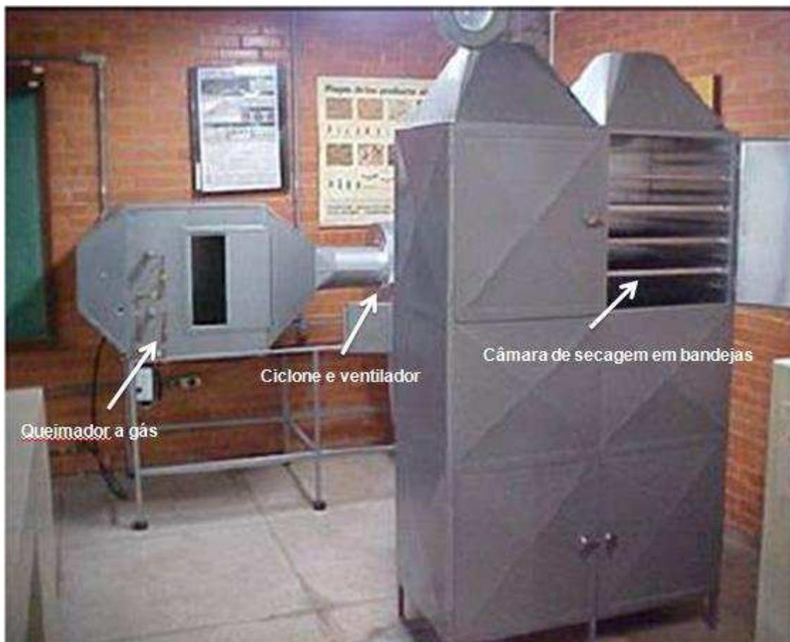
**Figura 4:** Secador de Amostras de Leite Fixo em Bandeja, com fluxo de ar contínuo e com queimador a gás.
