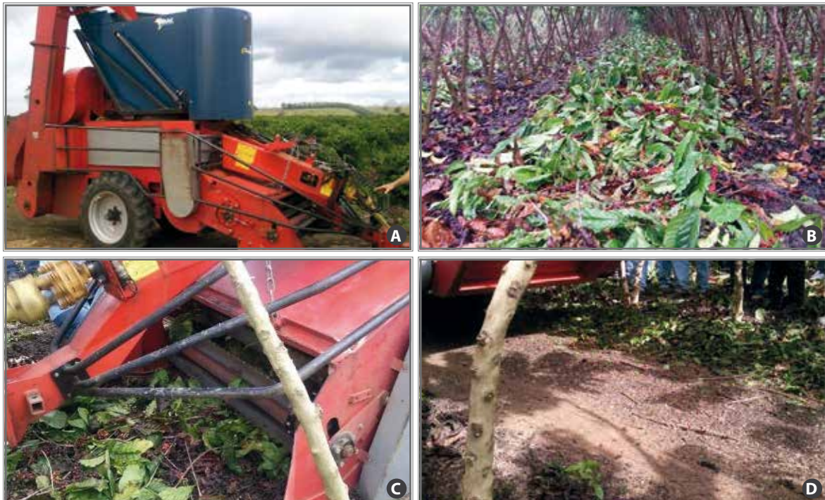
Figura 1. Máquina usada no recolhimento de frutos do cafeeiro conilon derrçados sobre o solo (A); detalhe da derrça associada à poda (B); da operação de recolhimento do material vegetal (C); e imagem após a passagem da máquina (D), na safra de 2012/13, em Nova Venécia/ES.
