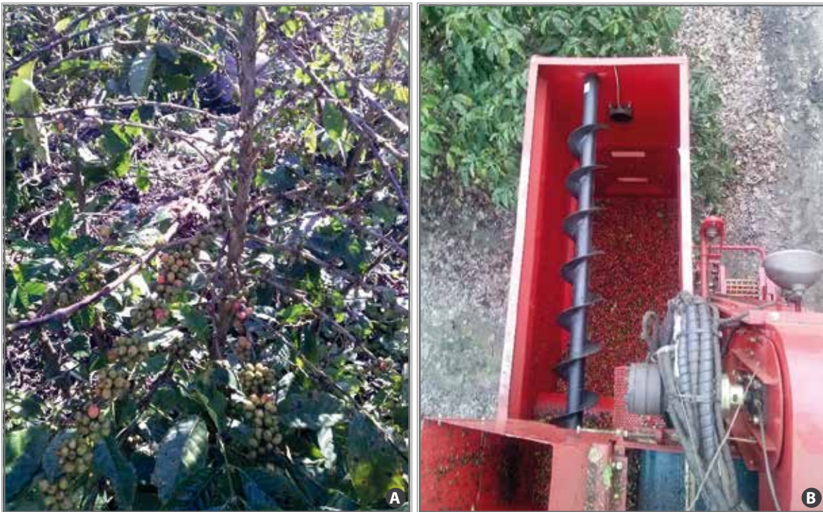
Figura 7. Seletividade na colheita dos frutos do cafeeiro conilon usando uma máquina automotriz de varetas na safra 2013/14, em Pinheiros/ES. Frutos verdes aderidos nos ramos plagiotrópicos (A); e frutos maduros colhidos pela máquina (B).
