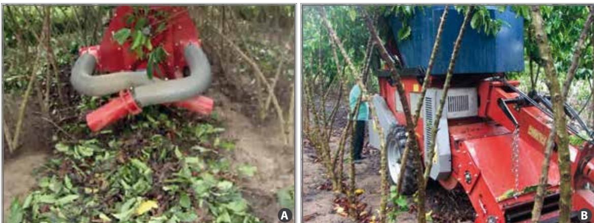
Figura 11. Soprador tracionado por trator usado no enleiramento do material vegetal antes do recolhimento de frutos derrçados sobre o solo (A); e processo de recolhimento do chão (B), na safra 2012/13, em Nova Venécia/ES.
