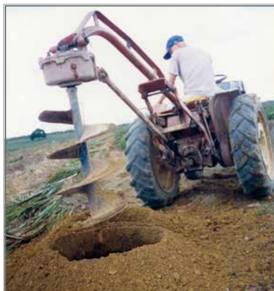
Figura 6. Brocão – broca de solo com diâmetro de 18” empregada na abertura de covas.
