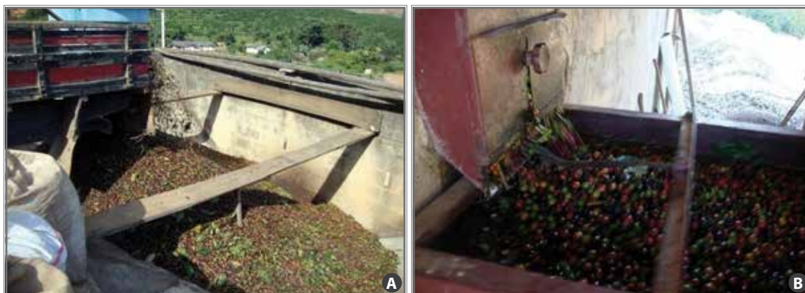
Figura 2. Frutos do café sendo descarregados na moega (A); abertura de saída da moega (B).
