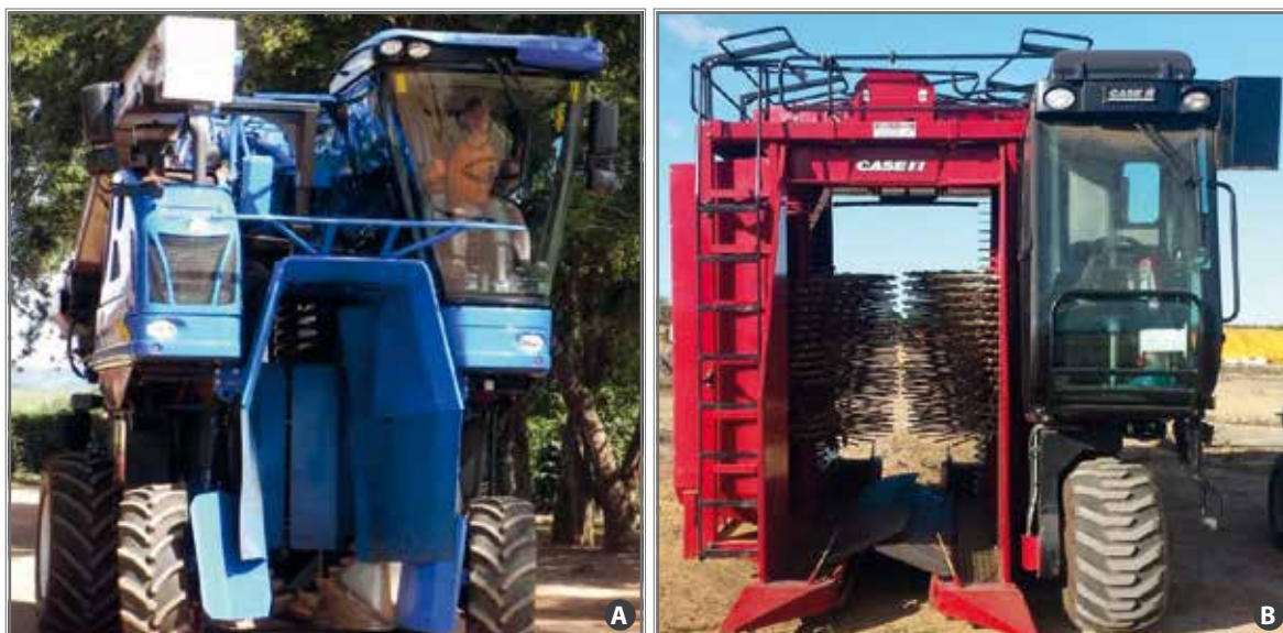
Figura 4. Colhedora automotriz com bastões Braud New Holland (A) e com varetas Case IH (B) em teste para o cafeeiro conilon, nas safras de 2014/2015, em Pinheiros/ES e São Mateus/ES, respectivamente.
