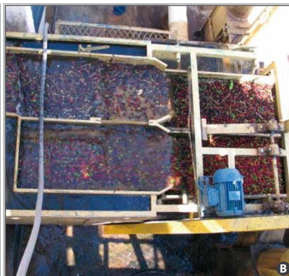
Figura 4. Lavagem em caixas d’água e remoção do café boia com peneira (A); separação dos frutos de café boia dos verdes e cerejas no lavador mecânico (B).
