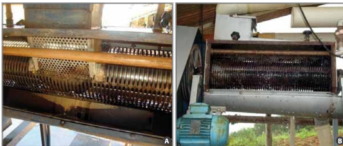
Figura 5. Cilindro descascador de frutos de café (A); tubo com orifícios para lançar água - esguicho - sobre o cilindro descascador (B).
