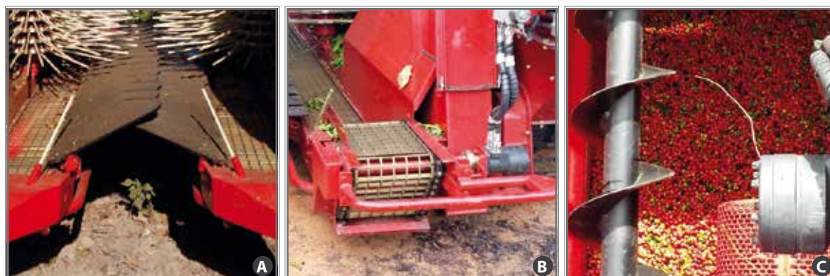
Figura 6. Detalhes da colhedora de varetas Case IH com placas plásticas de vedação inferior com transportadores laterais (A), elevadores (B) e tanque graneleiro (C).
