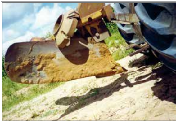
Figura 1. Sulcador alado de profundidade e largura variáveis, empregado na implantação das lavouras em solo de relevo plano.
