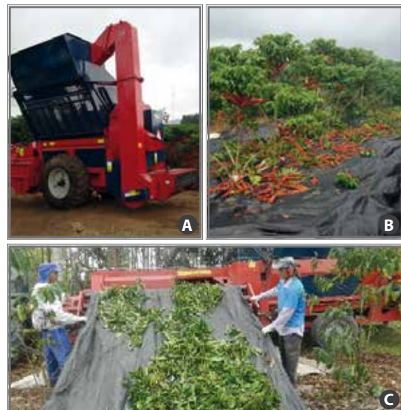
Figura 3. Máquina adaptada para o recolhimento de folhas, ramos e frutos (A) sobre a lona (B) e detalhe da lona sendo enrolada (C) na safra de 2014/15, em Jaguaré/ES.
