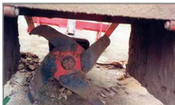
Figura 5. Detalhe interno do batedor de covas.
