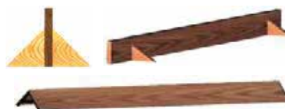
Figura 12. Detalhes das divisórias móveis para separação dos diferentes tipos de café.
