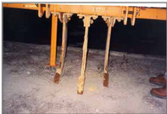
Figura 3. Subsolador de três hastes para rompimento de camadas compactas do solo e mistura dos adubos.
