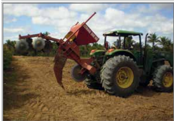
Figura 9. Subsoladores de 1 haste para subsolagem a profundidades de 80 a 90 cm, com aplicador de fertilizantes em profundidade.
