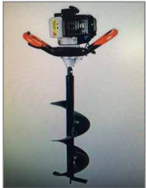
Figura 8. Perfurador de solo a gasolina, 63 cilindradas, 7500 RPM e 3,5 HP, para abertura de covas.
