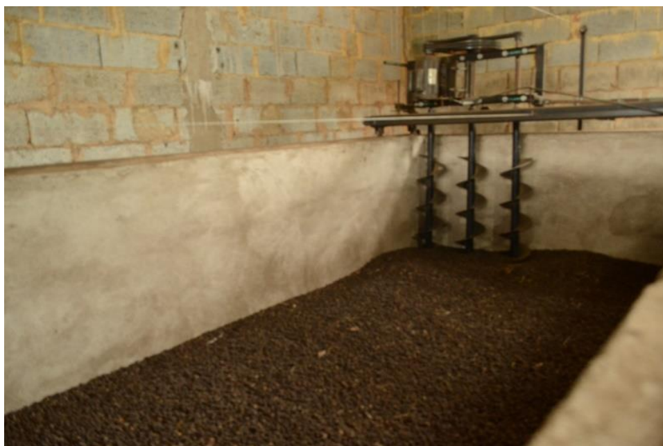
Figura 26 – Montagem completa do revolvedor em funcionamento com os frutos de café alocados na câmara de secagem.
