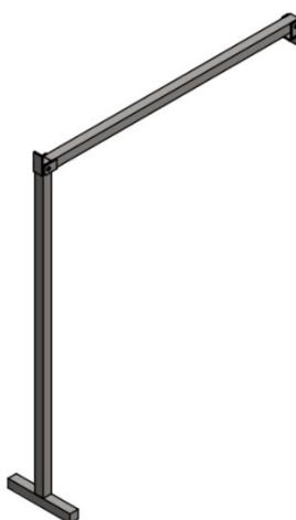
Figura 21 – Leiaute final do sistema responsável de deslocamento transversal do revolvedor.
