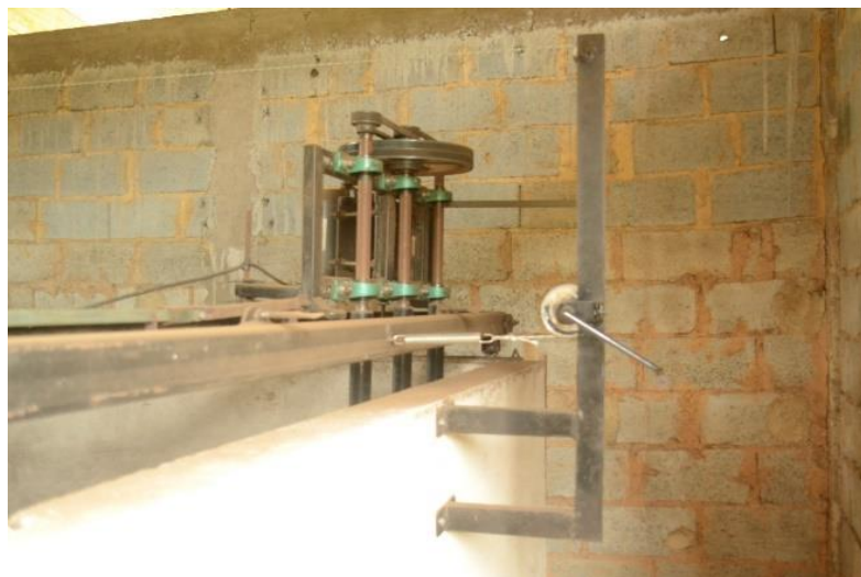
Figura 24 – Sistema de deslocamento do revolvedor, apresentando o suporte da manivela.
