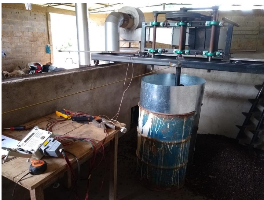
Figura 9 – Montagem do medidor de grandezas universais (MUG) modelo ELO 2160.
