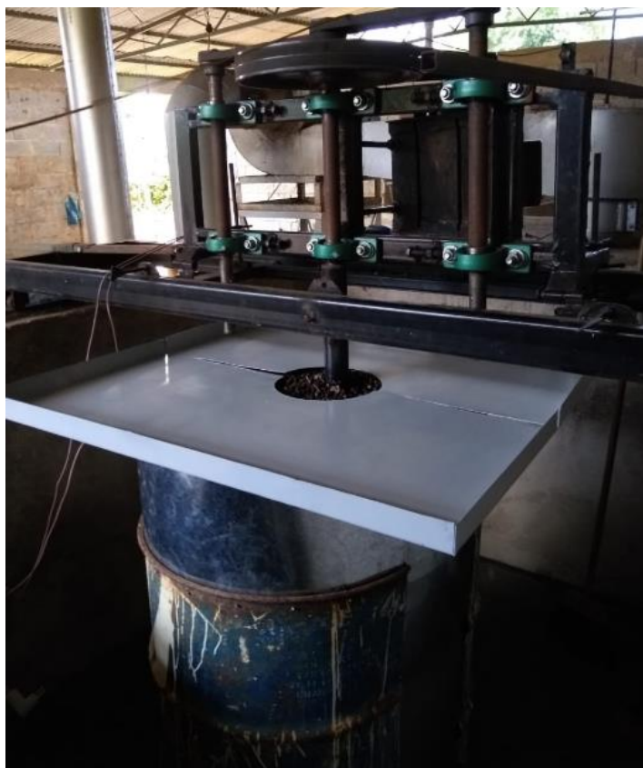
Figura 5 – Disposição dos elementos para realização dos ensaios de eficiência de transporte.
