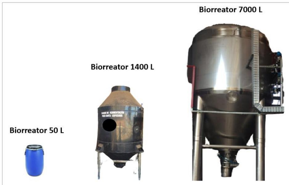
Fig. 1. Escalonamento dos biorreatores utilizados para fermentação de café.
