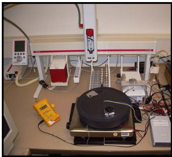
Figura 1 – Sistema analítico composto pelo microtrap, unidade de CG e detector com sensores do tipo SAW
