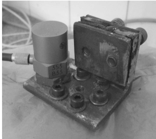
Figura 9: Sistema de fixação das amostras e suporte do transdutor piezoelétrico.
