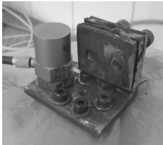
Figura 35: Sistema de fixação das amostras e suporte do transdutor piezoelétrico.
