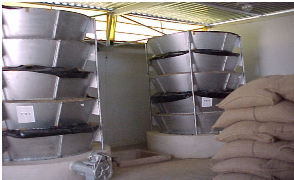
FIGURA 1 – Silos metálicos modulares com e sem aeração, e armazenagem em sacos de juta.
