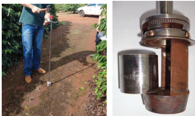
Figura 2 Extrator de amostras indeformadas (esquerda) e detalhe do cilindro (direita) utilizado na extração da serapilheira mais solo na projeção da copa dos cafeeiros
