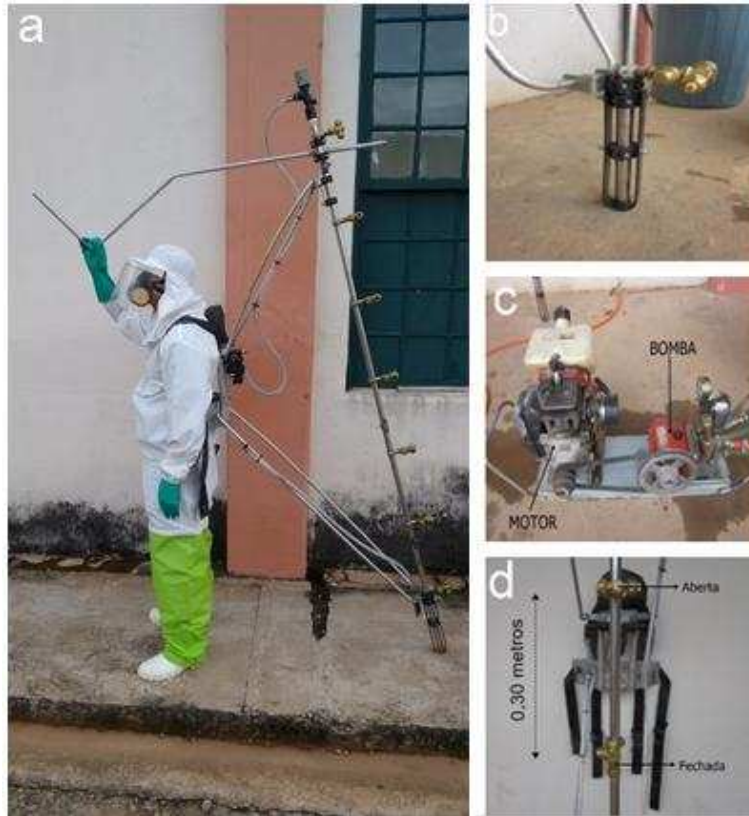
Figura 1: Barra porta bicos (Foguetinho) equipada com 14 pontas de pulverização XR 8002 distribuídas em sete sessões com duas pontas cada e detalhe da alça de manobra (a); detalhe do suporte de sustentação fixado na base da barra porta bicos (b); conjunto motobomba utilizado para pressurizar o sistema hidráulico (c) e detalhe do espaçamento entre sessões e movimento giratório (controle do fluxo) das sessões em torno do eixo (d).
