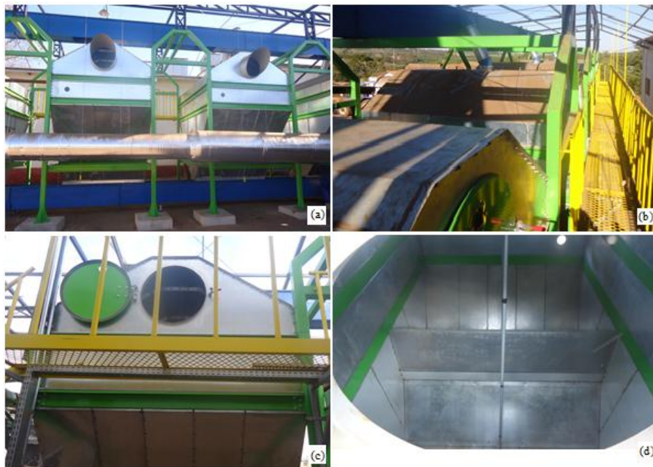
Figura 2 (a) Dois dos cinco módulos que compõe o sistema. (b) Vista superior dos módulos e passarela de acesso. (c) Janela de visória. (d) interior dos módulos
