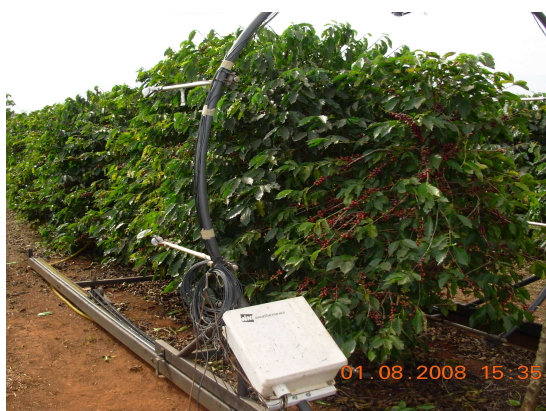
Figura 3 - Vista do sistema de medida no cafezal, com o arco sustentando saldo-radiômetros, trilho e sistema de tração e o sistema coletor de dados (“datalogger”) solidário
