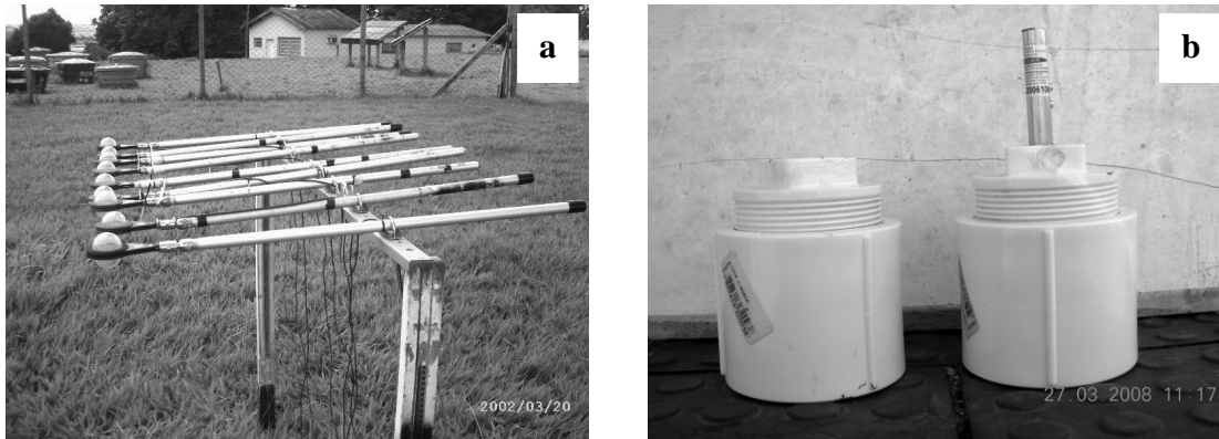
Figura 7 - Calibração dos sensores antes do início do experimento (a); foto ilustrativa do sistema desenvolvido para posicionamento dos saldos-radiômetro (b)
