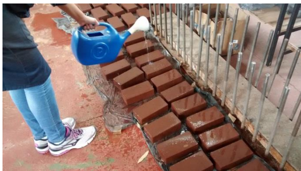
Figura 11 - Processo de cura dos tijolos.
