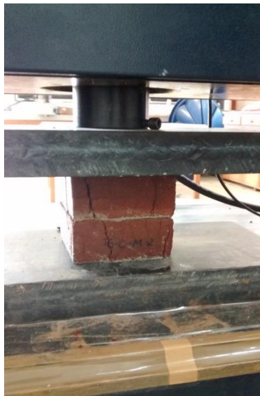
Figura 13 - Tijolos de solo-cimento no ensaio de compressão.
