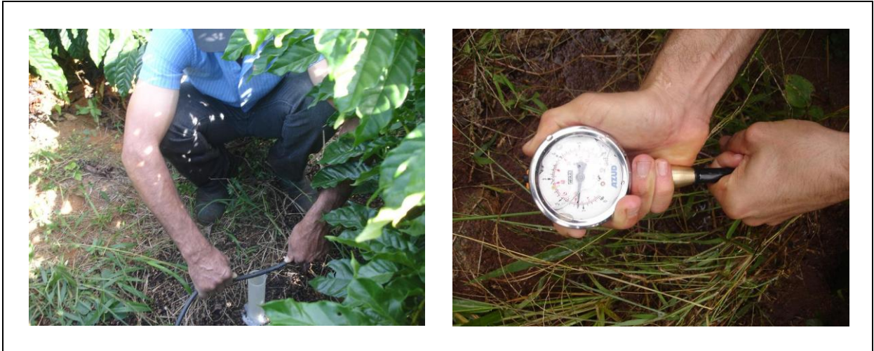
Figura 12 – Detalhe da coleta das vazões e da pressão de serviço no final da linha no projeto de irrigação localizada.
