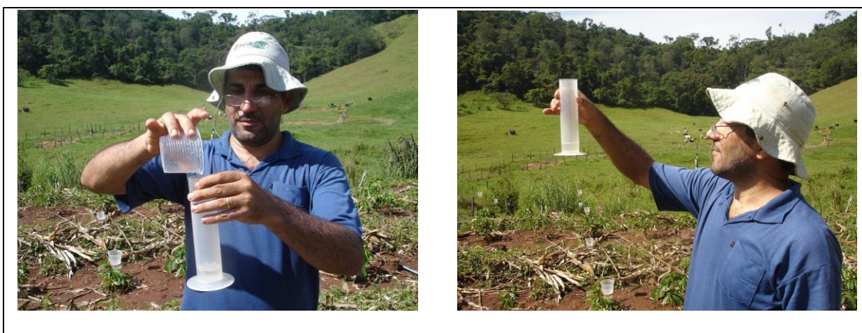
Figura 5 - Coleta das lâminas de água no sistema de irrigação por aspersão fixa.
