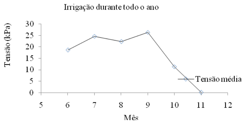
FIGURA 7. Tensão média mensal monitorada no tratamento nº 2 (irrigação durante todo o ano) no período de junho a novembro de 2007 com a utilização de um tensímetro digital.
