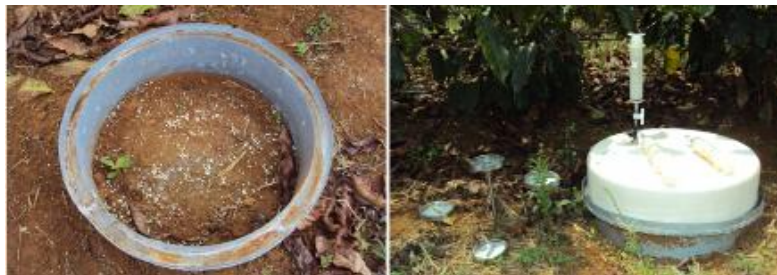
Figura 3.2 - Câmara de coleta de gás para estimar a desnitrificação do nitrogênio aplicado
