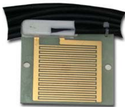
Figura 3.2 - Sensor eletrônico de medida da duração do período de molhamento foliar (DPM), sem pintura, utilizado nas micro-estações automáticas, mostrando o detalhe dos dois pentes intercalados. Fonte: www.campbellsci.com .
