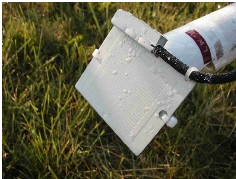
Figura 5.1 - Detalhe de um sensor de DPM da Campbell Sci., Modelo 237, montado em uma secção de um tubo de PVC.
