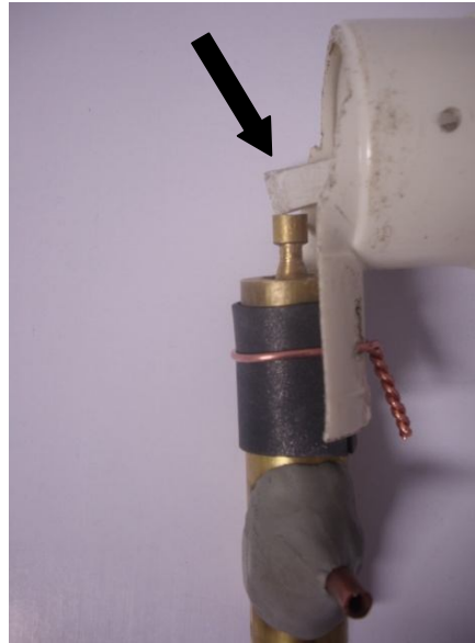
Figura 13 - Protótipo 2 do sistema de acionamento da válvula de 3 vias
