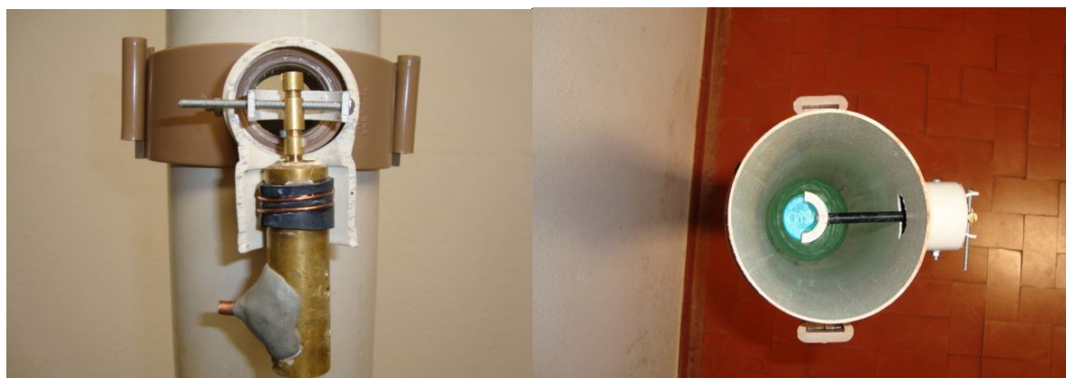
Figura 12 - Protótipo 1 do sistema de acionamento das válvulas de 3 vias
