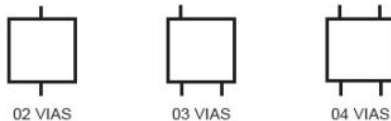
Figura 4 - Representação gráfica do número de vias de uma válvula direcional Fonte: Gomes, Andrade e Ferraz (2008)
