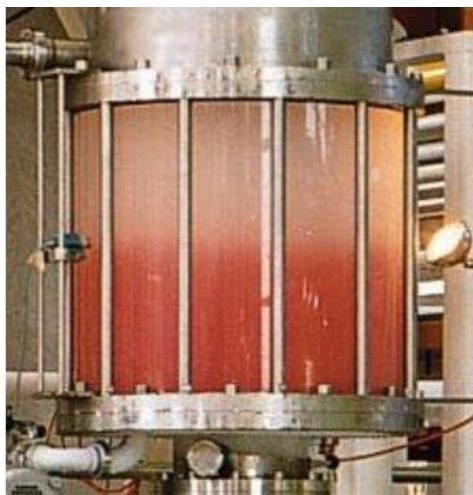
Figura 2-8: Interface de separação cristais de gelo e extrato de café (Freeze Concentration - GEA, 2013).
