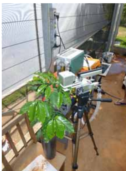
Figura 7. Avaliação de trocas gasosas com IRGA no cafeeiro.
