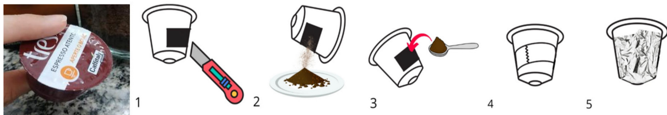
Figura 3. Procedimento de preparo das cápsulas com as amostras de café: 1: abertura da cápsula com estilete; 2: a cápsula foi esvaziada e limpa; 3: a amostra de café foi adicionada à cápsula limpa; 4: fechamento da cápsula com cola e fita adesiva; 5: cápsula envolta em papel alumínio
