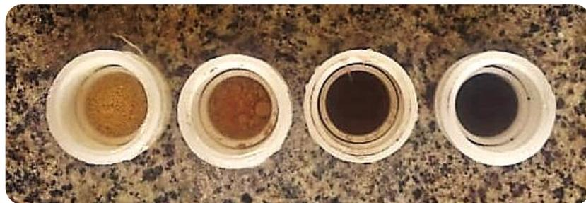
**Figura 1.** Coloração do defeito PVA e dos *hydrochars* em função das temperaturas de carbonização hidrotérmica.
