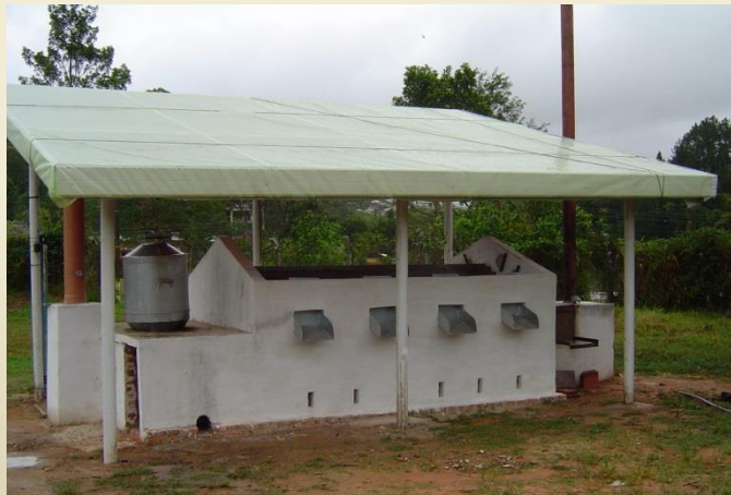
Secador Solar para a Agricultura Familiar (UFV/EMBRAPA-Café) Na ausência da radiação solar, funciona com lenha ou com carvão.
