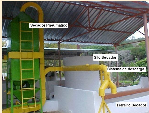
Sistema combinado de secadores ( UFV/EMBRAPA-Café).
