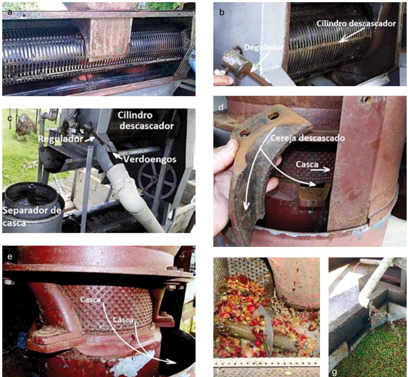
**Figura 12.** Cilindro do descascador (a, b), entrada dos grãos descascados e da casca no separador de cascas (c, d, e), remoção da casca (f) e bicas de saída do café cereja descascado e dos frutos verdes (g).
