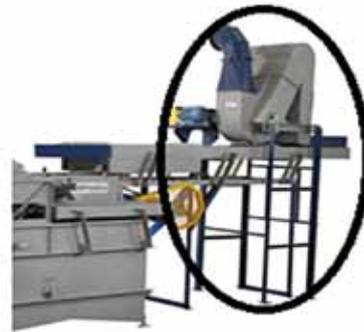
**Figura 10.** Lavador equipado com pré-limpeza.
