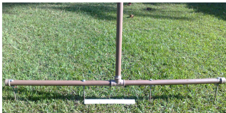
Figura 7. Configuração da Matriz de Wenner com espaçamentos entre eletrodos de 0,40 m.
