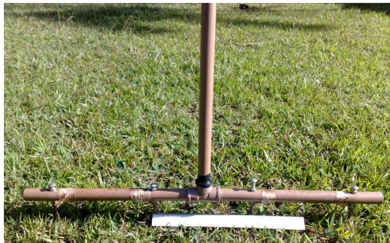
Figura 6. Configuração da Matriz de Wenner com espaçamentos entre eletrodos de 0,20 m.
