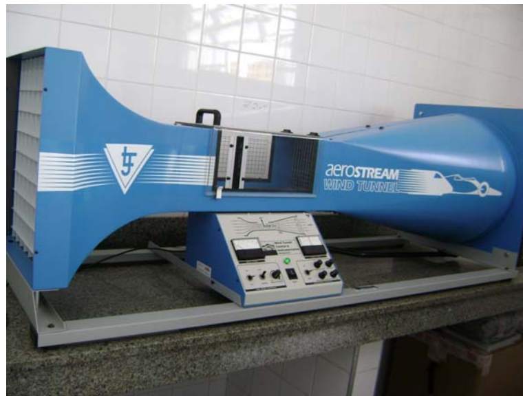
Figura 2 – Túnel de vento utilizado para a determinação do coeficiente de arrasto.
