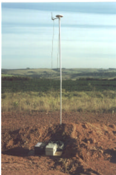
Figura16- Base estacionária com o receptor GPS fixo montada no campo.
