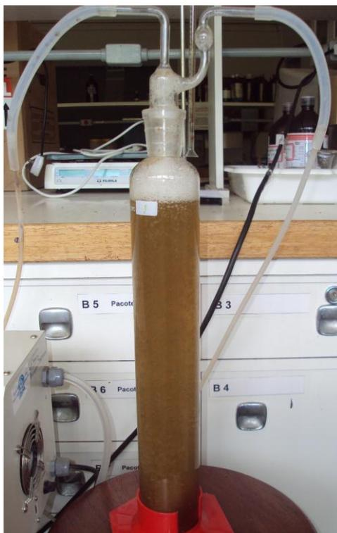
Figura 6 – Frasco lavador que foi utilizado para o processo de ozonização da água residuária dos frutos do cafeeiro.
