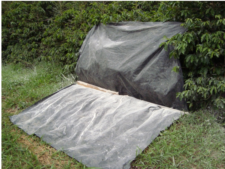
Figura 8 Lona utilizada para avaliar a aplicação, à taxa variável em cafeeiro
