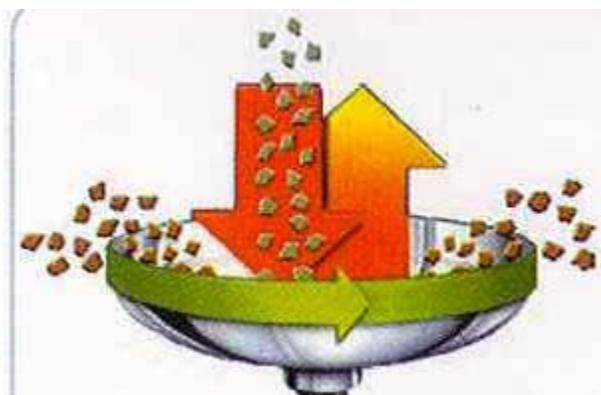
**FIGURA 4** Câmara de torração no formato tigela (Probat, 2004).
