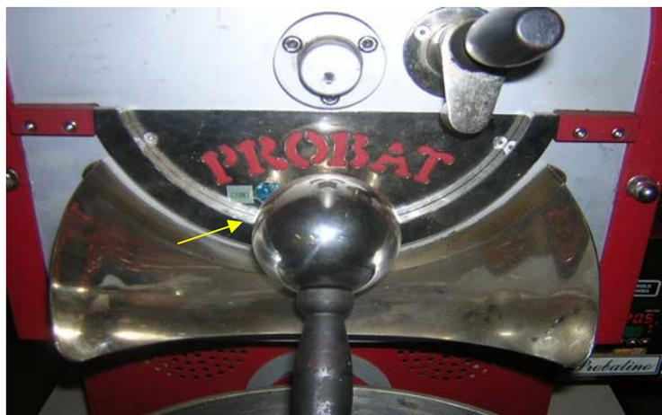
**FIGURA 6** Indicação da localização do termopar e legenda de calibração na porta da câmara de torração fechada.
