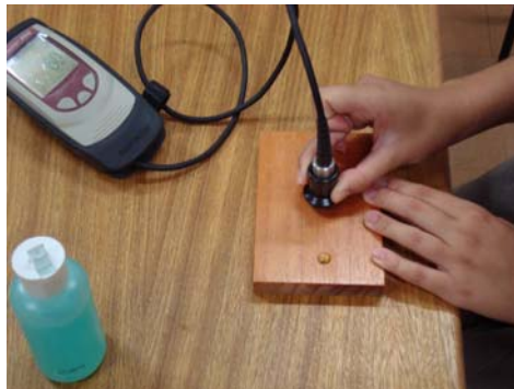
Figura 22 Ensaio para mensuração da espessura da camada seca de verniz
