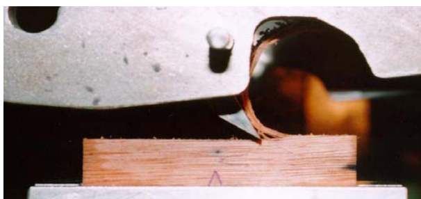
Figura 7 Cavaco Tipo I obtido em ensaio ortogonal 90^{\circ} - 0^{\circ}
