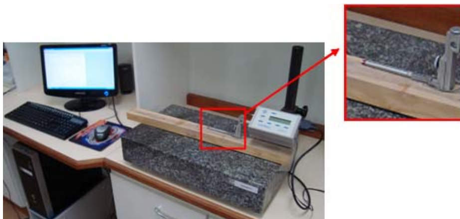
Figura 17 Análise da rugosidade realizada por um rugosímetro de arraste
