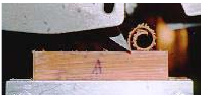
Figura 8 Cavaco Tipo II obtido em ensaio ortogonal 90°-0°
