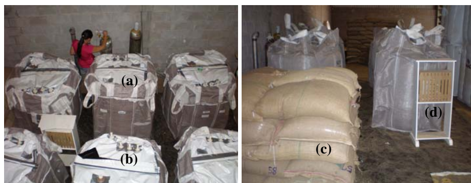
FIGURA 1 Área experimental: (a) distribuição do big-bag revestido com sistema de injeção de CO 2 ; (b) big-bag revestido sem injeção de CO 2 ; (c) pilha contendo sacos de juta e sacos de juta revestido; (d) termo-higrógrafo.
