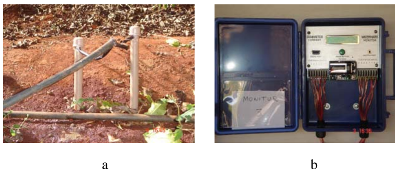
Figura 4 Sensores de água no solo localizados aos 10 cm e aos 30 cm de profundidade (a) e o monitor Watermarck para aquisição dos dados (b)
