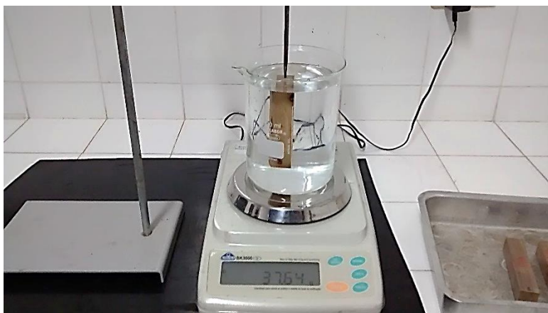
Figura 37 - Balança de precisão e becker com água destilada, com amostra do tronco cafeeiro.
