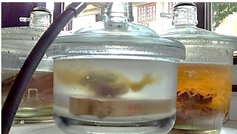
Figura 36 - Cuba de Vácuo contendo amostra de tronco cafeeiro.
