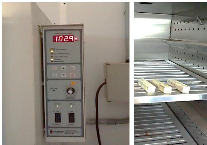
Figura 35 - Câmara de secagem com amostras de tronco cafeeiro.
