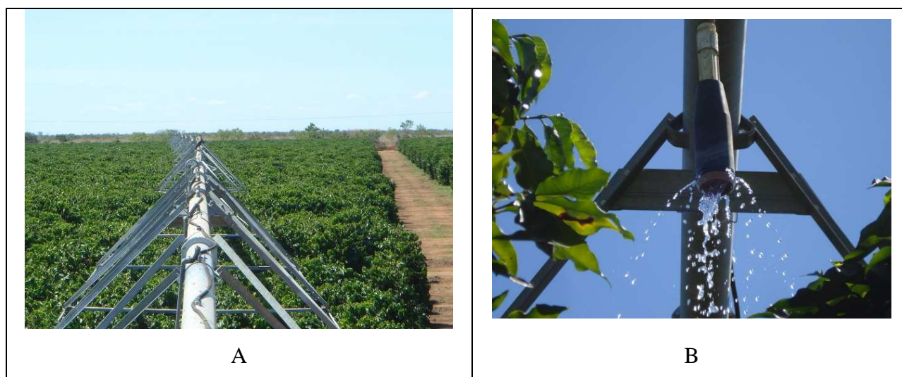
Figura 2.1 – Geral da área do cafezal com pivô-central (A) e emissores do tipo LEPA (B)
